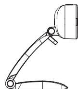
Repliez le pied de fixation de la webcam pour la poser sur une surface plane.
