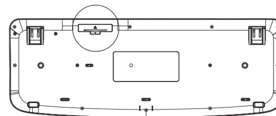
5. Insérez ensuite deux piles dans le clavier en vous assurant de respecter les polarités. Remplacez ensuite le couvercle du compartiment à piles.
