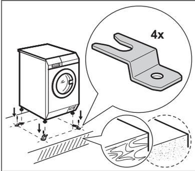
Si vous installez l'appareil sur un sol en béton, veillez à commander le kit de fixation adapté.
