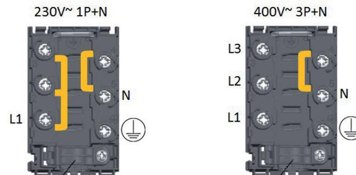
3. Dénudez environ 70 mm de gaine du cordon d'alimentation. Dénudez les fils électriques sur une longueur de 10 mm.
