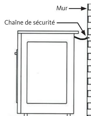
Cette cuisinière doit être attachée solidement au mur avec la chaîne de sécurité (qui se trouve au dos de l'appareil) avec un moyen de fixation adapté à la nature de votre mur pour éviter tout risque de basculement (voir figure ci-contre).
