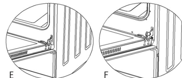
2. Tirez le verrou de la charnière (figure E) vers le haut à l'aide d'un tournevis, et placez-le sur la position la plus haute (figure F).
