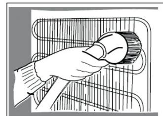
7. Au moins une fois par an, ôtez la poussière accumulée sur la partie arrière de l'appareil. Utilisez pour cela une brosse douce, un tissu électrostatique ou un aspirateur (schéma ci-contre).
