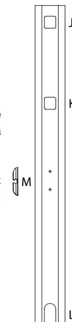
**!** Nous vous recommandons de passer les câbles de connexion (électriques notamment) dans les deux ouvertures (J et K) avant de visser le support TV sur le pied.
