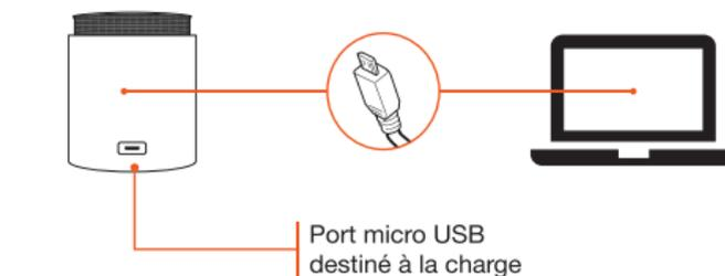
1. Connectez l'enceinte à un port USB de votre ordinateur via le câble de charge USB fourni. Vous pouvez également utiliser un chargeur secteur USB (non fourni).
