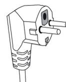
Ce four à micro-ondes est équipé d'une prise électrique de terre. Il doit être branché sur une prise murale correctement installée et équipée d'une prise de terre.
