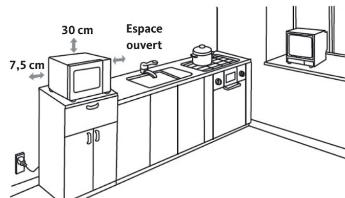
**AVERTISSEMENT :** N'installez pas votre four sur une table de cuisson ou sur un appareil produisant de la chaleur. Votre four risque d'être endommagé et la garantie ne s'applique pas dans ce cas.
