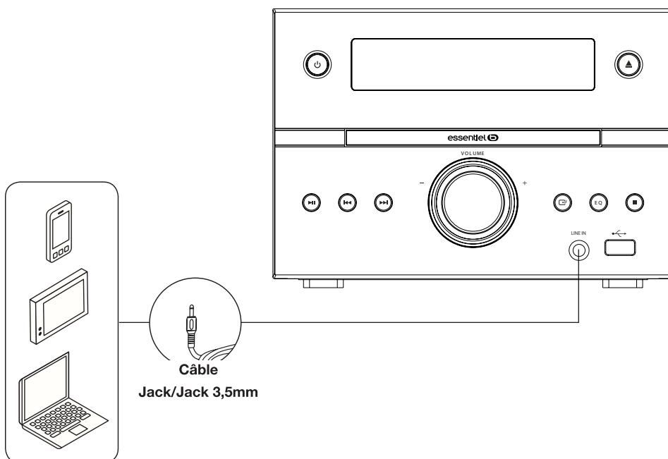
1. Branchez l'extrémité d'un câble Jack 3,5mm /Jack 3,5mm (non fourni) dans la prise LINE IN située à l'avant de l'appareil.
