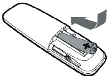
2. Positionnez la pile dans le boîtier en respectant les indications de polarité + et - indiquées.
