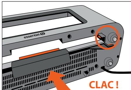
**ATTENTION ! Pour que l'appareil fonctionne, l'insertion du panneau en verre doit être totale afin d'enclencher l'interrupteur de sécurité.**
