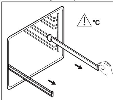
2. Placez la grille métallique sur les rails télescopiques et poussez-les dans le four.
