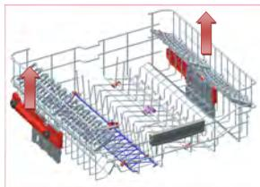
Le mécanisme de réglage de la hauteur du panier supérieur de votre machine a été conçu pour vous donner la possibilité d'abaisser ou de réhausser le panier supérieur sans avoir à le retirer lorsqu'il est plein. Cela permet de créer des espaces de rangement plus hauts ou plus bas entre les paniers supérieur et inférieur. Le panier supérieur est réglé en position supérieure en réglage d'usine.
