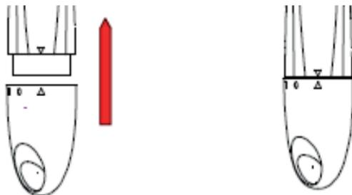
1. Retirez le capot du compartiment à pile en déplaçant le curseur du corps de l'appareil vers la droite.
