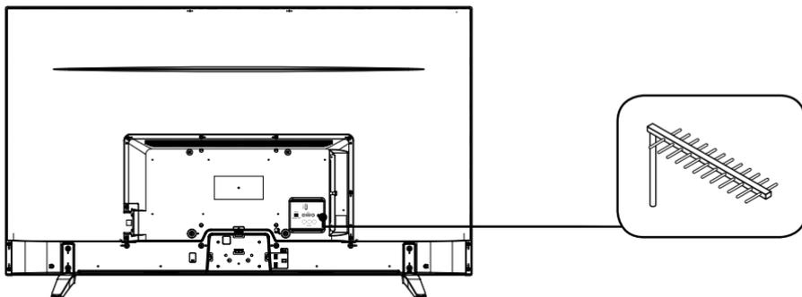
Afin d'obtenir la meilleure qualité d'image par voie hertzienne, il est fortement recommandé d'utiliser une antenne extérieure. Raccordez l'antenne à la prise d'entrée de l'antenne située au dos du téléviseur. La qualité de l'image varie en fonction de la qualité de votre réception.
