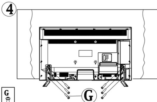
Pour terminer, utilisez un tournevis pour serrer les deux jeux de vis sous chaque pied. Ne serrez pas exagérément, pour éviter d'endommager les parties en plastique.
