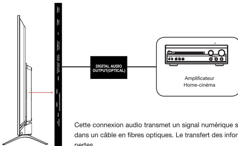
Cette connexion audio transmet un signal numérique sous forme d'impulsions dans un câble en fibres optiques. Le transfert des informations s'effectue sans pertes.
