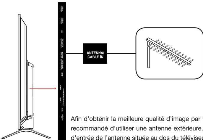
Afin d'obtenir la meilleure qualité d'image par voie hertzienne, il est fortement recommandé d'utiliser une antenne extérieure. Raccordez l'antenne à la prise d'entrée de l'antenne située au dos du téléviseur. La qualité de l'image varie en fonction de la qualité de votre réception.
