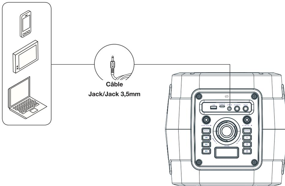
1. Branchez l'extrémité d'un câble Jack 3,5 mm / Jack 3,5 mm (non fourni) dans la prise LINE IN située sur le panneau de commandes de l'enceinte.
