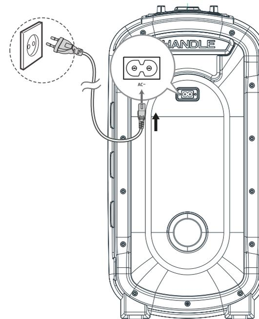
Branchez une extrémité du câble d'alimentation sur le connecteur d'alimentation situé au dos de l'enceinte. Puis branchez l'autre extrémité sur une prise murale. L'appareil est alors prêt à fonctionner.
