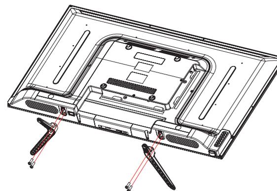
Sortez les deux pieds de l'emballage, puis fixez-les sur la partie inférieure de part et d'autre de l'appareil, comme indiqué sur le schéma ci-contre.
