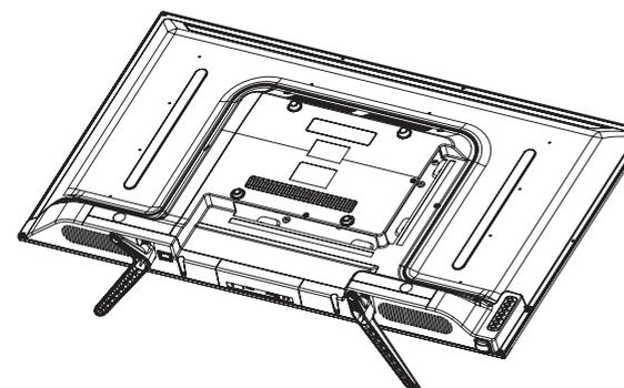
Utilisez un tournevis pour serrer les deux jeux de vis sous chaque pied. Ne serrez pas excessivement, pour éviter d'endommager les parties en plastique.
