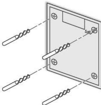
② Percez les trous en utilisant une perceuse électrique et une mèche à béton de 8 mm.
