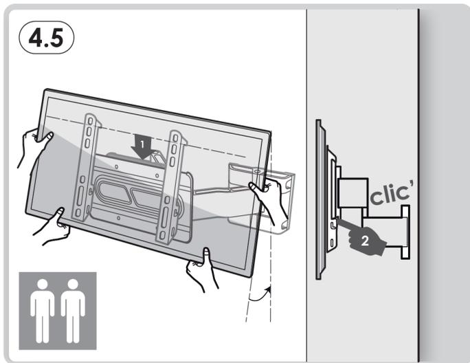
Pour terminer l'installation au mur de votre écran, placez avec précaution les supports du téléviseur sur les barres de montages transversales inférieures et supérieures. Placez le téléviseur au centre de la barre transversale.
