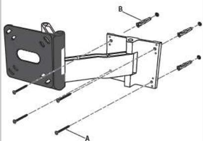
③ Insérez une cheville à béton **(B)** dans chaque trou. Si nécessaire, vous pouvez utiliser un marteau pour taper légèrement sur chaque cheville, afin qu'elles soient au même niveau que le mur.
