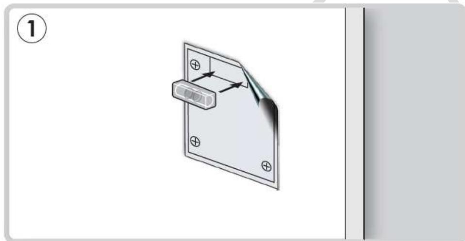
① Commencez par positionner le gabarit de perçage contre le mur en utilisant le niveau à bulle pour le tenir droit.
