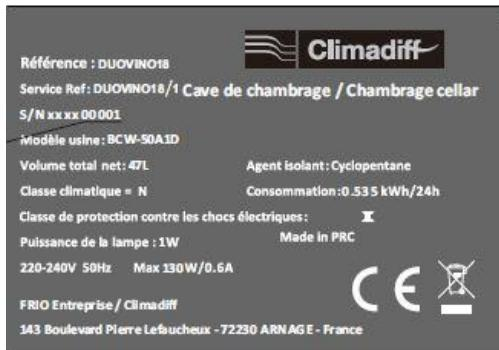
La targhetta informativa incollata all'interno o sul retro dell'apparecchio (a seconda del modello) contiene tutte le caratteristiche tecniche del frigo cantina.
