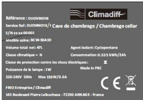
Das Typenschild befindet sich im Geräteinneren bzw. an der Geräterückseite (modellabhängig). Es enthält alle gerätespezifischen Angaben.
