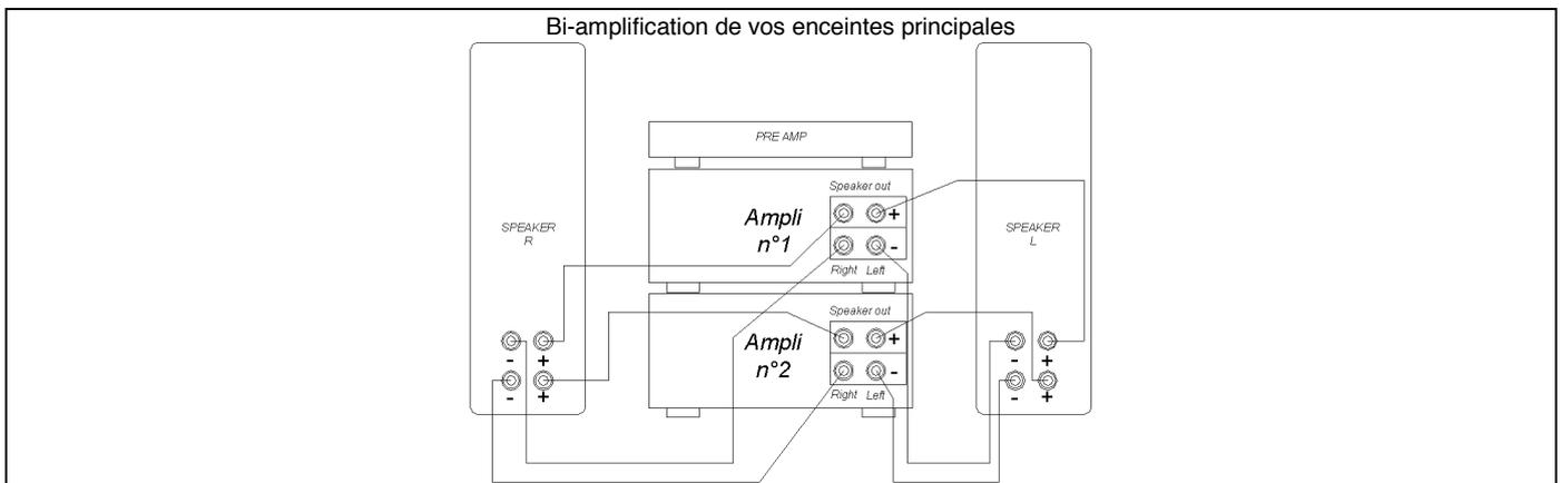
A défaut d'utiliser deux amplificateurs, vous pouvez n'en utiliser qu'un seul, si ce dernier dispose de deux groupes d'enceintes A et B. Il faudra sélectionner les deux groupes. Il s'agit alors de bicâblage et non de bi-amplification.
