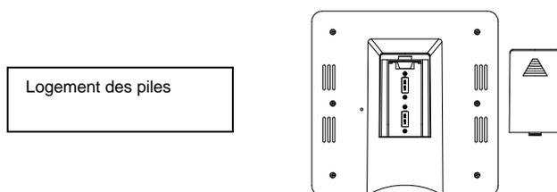
La station météo fonctionne avec 2 piles 1,5V de type C, IEC LR14.
