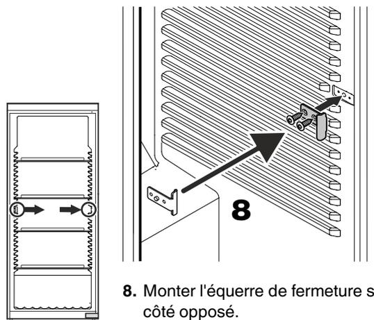
8. Monter l'équerre de fermeture sur le côté opposé.
