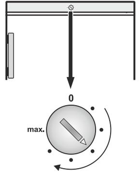
Plus le régulateur est tourné vers la position **max.**, plus la température est basse à l'intérieur de la cuve.
