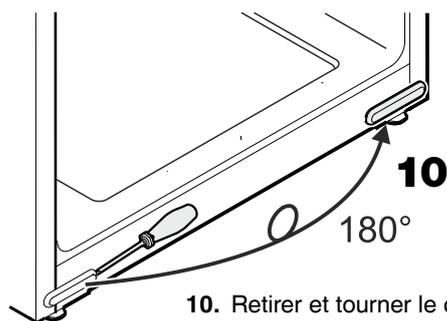
10. Retirer et tourner le cache à 180° pour le positionner sur le côté opposé.
