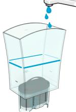
Wassertank hin- und herschwenken, um Luftblasen aus dem Filter zu entfernen.
