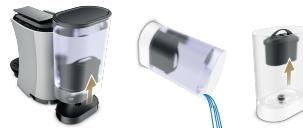
Wassertank entfernen und entleeren. Wasserfilter entfernen.
