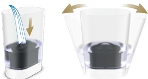
Neuen Filter anbringen. Wassertank bis zur Hälfte mit frischem Trinkwasser füllen. Wassertank anschließend hin- und herschwenken, um Luftblasen aus dem Wasserfilter zu entfernen.
