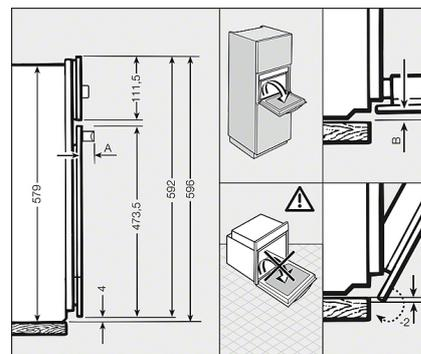
Schéma détaillé H 6000, H 5000, H 4000, E/B, EP/BP, 76 litres, (schéma)
