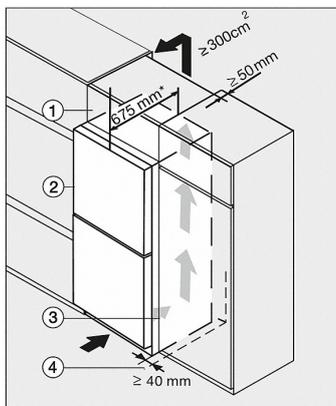
KFN29233D, KFN29243D, KFN29493DE, KF29283D, KFN29283D, KFN29483D, KFNS28463E, KWNS28462E (schéma)
