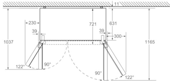
Plateaux réfrigérés entièrement amovibles à un angle d'ouverture de porte de 122°
