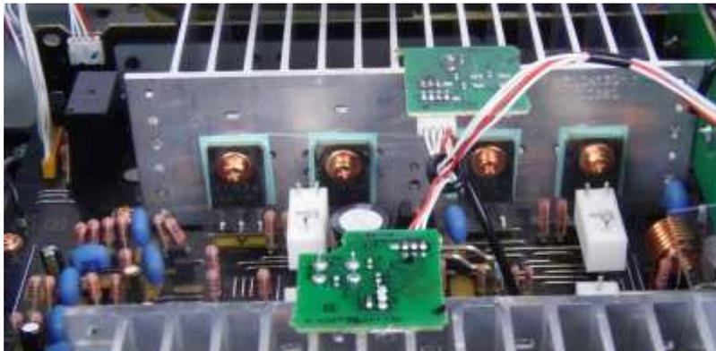
Les composants passifs utilisés sont de qualité ; il s'agit de condensateurs à couches et résistances de puissance double cémentées non inductives et permettant une égalisation de la température sur chaque polarité d'amplification, des éléments ne pouvant qu'être favorables à la restitution sonore.
