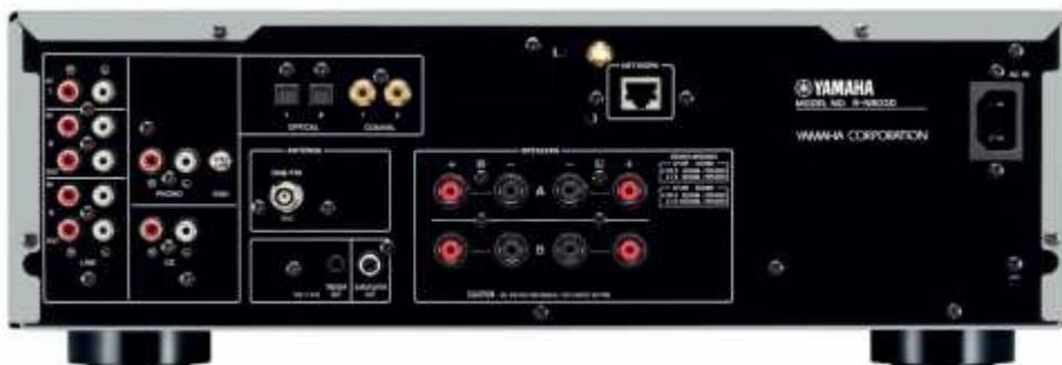
On trouve donc un certain nombre de paires de prises Cinch pour les branchements analogiques, dont une entrée CD, une pour Phono avec sa vis de mise à la masse de la platine vinyle, trois entrées stéréo simplement numérotées de 1 à 3, les 2 et 3 étant doublées d'une sortie stéréo, celles-ci pouvant donc être incluses dans la boucle de monitoring d'un enregistreur pour contrôler en temps réel le signal enregistré.
