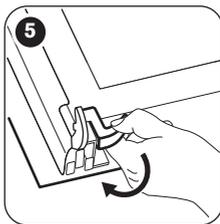
5 Désengagez le système de verrouillage pour retirer le panneau de verre intérieur.
