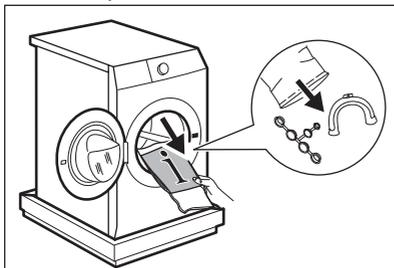
2. Mettez les éléments d'emballage au sol derrière l'appareil et posez-le délicatement sur sa partie arrière. Retirez la protection en polystyrène
