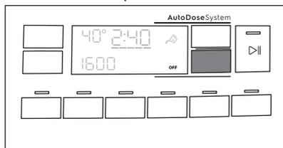
5. Pour régler le dosage de base, appuyez sur les touches correspondant aux réservoirs jusqu'à ce que le dosage de produit de lavage et deux flèches s'affichent en bas de l'écran. Appuyez à plusieurs reprises sur la touche Température pour augmenter le dosage et sur la touche Essorage pour le diminuer. Le minimum est de 1 ml.
