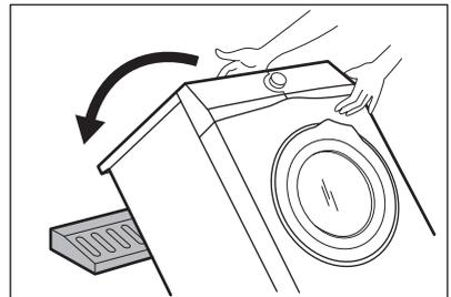
5. Retirez la protection en polystyrène en bas de l'appareil. Redressez l'appareil en position verticale.
