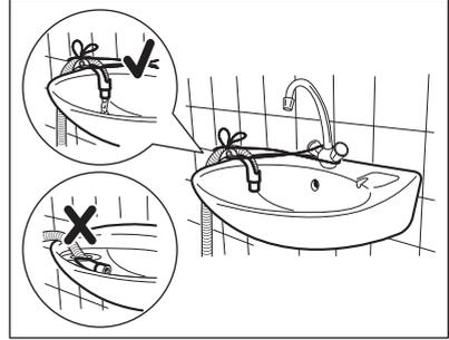
**i** Veillez à ce que le guide de tuyau en plastique ne puisse pas se déplacer lors de la vidange de l'appareil, et que l'extrémité du tuyau de vidange ne soit pas immergée dans l'eau. Il pourrait y avoir un reflux d'eau sale dans l'appareil.
