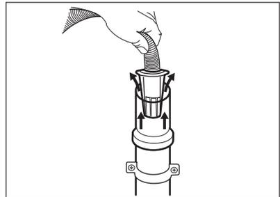
4. À une conduite fixe dotée d'une ventilation spéciale : insérez directement le tuyau dans la conduite d'évacuation. Reportez-vous à l'illustration.
