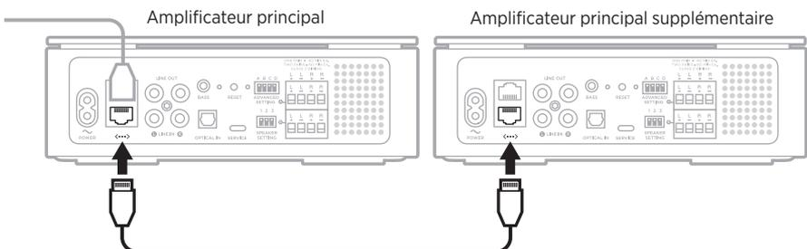
Vous pouvez raccorder un amplificateur secondaire à l'amplificateur principal ou à un autre amplificateur secondaire à l'aide d'un câble audio RCA (non fourni).
