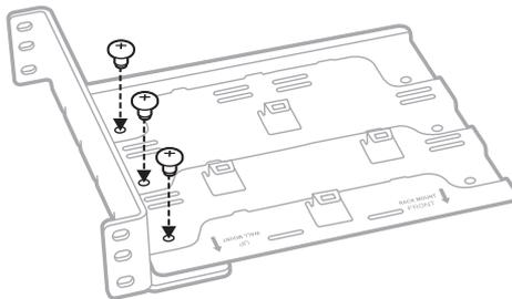
3. À l'aide d'un petit tournevis cruciforme, serrez les vis en les faisant pivoter dans le sens des aiguilles d'une montre.
