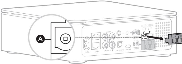
2. Raccordez les fils d'enceinte à la plaque à bornes A.
