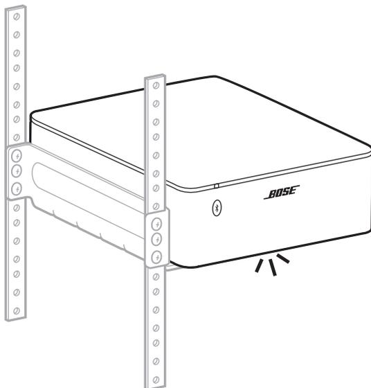
**REMARQUE :** pour retirer l'amplificateur du support de montage, déplacez l'amplificateur vers l'avant pour le dégager des ergots.
