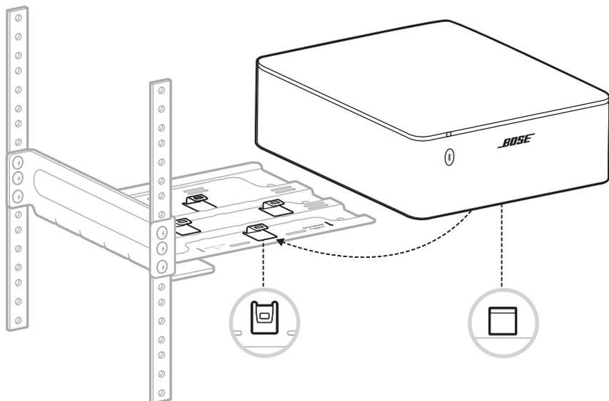
2. Insérez délicatement l'amplificateur dans les ergots jusqu'à ce qu'il se mette en place.
