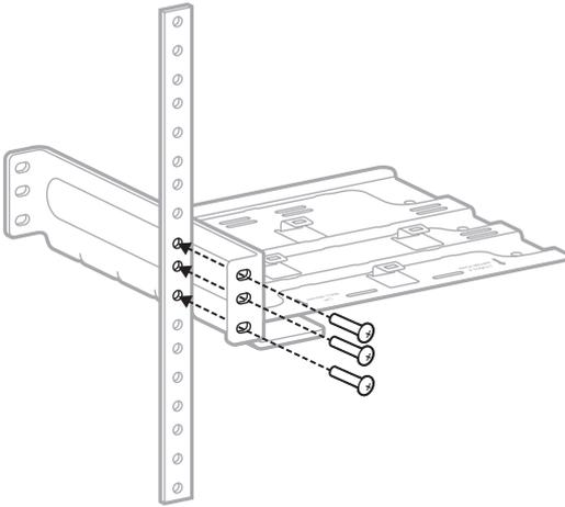
3. Serrez les vis dans le sens des aiguilles d'une montre pour les fixer.
