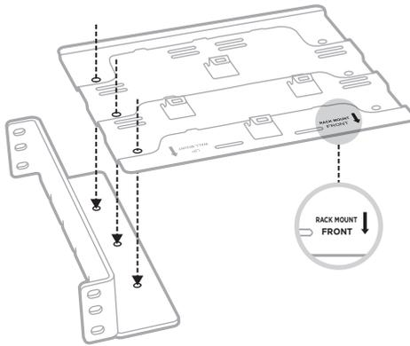
2. Insérez les vis de connexion dans le support de montage et dans le support du rack.
