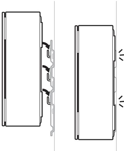
**REMARQUE :** pour retirer l'amplificateur du support de montage, déplacez l'amplificateur vers le haut pour le dégager des ergots.
