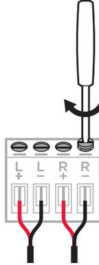
4. Réinsérez la plaque à bornes A dans le connecteur **SPEAKERS OUT**.
