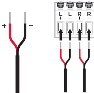
3. À l'aide d'un petit tournevis à tête plate, serrez les vis sur les bornes en les faisant pivoter dans le sens des aiguilles d'une montre de façon à fixer les fils.
