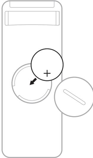
**REMARQUE :** utilisez uniquement une pile au lithium homologuée (p. ex., CE) de 3 volts, de type CR2032 ou DL2032.
