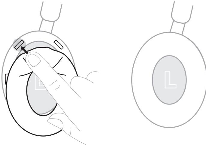
**ATTENTION :** pour optimiser les performances audio, les six languettes doivent être correctement fixées sur le coussinet.
