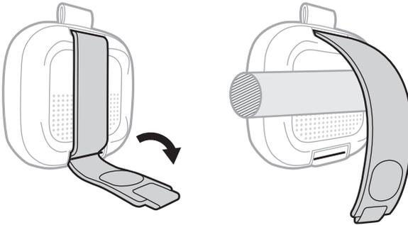
2. Faites passer la sangle dans le logement inférieur, serrez-la et fixez-la à l'aide de l'attache.
