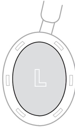
4. Alignez les six languettes de la bride de montage du coussinet sur les six fentes de l'écouteur, puis appuyez sur le coussinet jusqu'à ce que les six languettes s'enclenchent dans chaque fente. Vous entendez et sentez un déclic qui indique que le coussinet est correctement en place.
