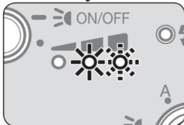
Lorsque l'éclairage DEL fonctionne à haute intensité et que la température interne atteint un certain point, le niveau d'intensité de l'éclairage DEL chute à une intensité moyenne [※] et le témoin indicateur de niveau d'intensité de l'éclairage DEL de droite, qui indique une intensité élevée, se met à clignoter lentement [※] comme indiqué ci-dessous.
