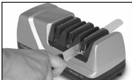
Figura 10. Usar sólo la etapa 3 para afilar cuchillos dentados.
