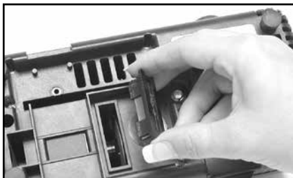
Figura 14. Quitar la cubierta debajo de la base para limpiar las limaduras de metal (Consultar la sección Mantenimiento Normal).
