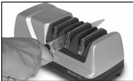
Figure 5. Affûtage à l'étape 2 (fente gauche).
