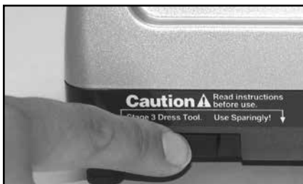
Figure 11. Utilisez les outils de dressage parcimonieusement (voir la page suivante pour les instructions).
