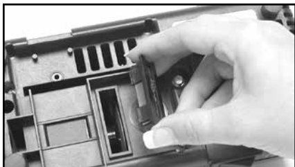
Figure 14. Retrait du couvercle sous la base pour nettoyer la poussière de métal (voir la section Entretien normal).
