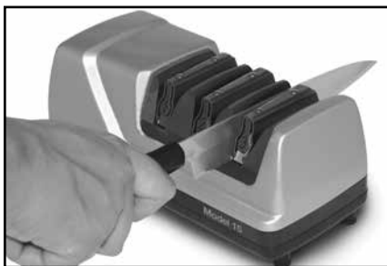
Figure 8. Affiler/polir un couteau japonais traditionnel de droitier à l'étape 3.
