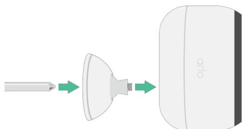
**Remarque :** La caméra extérieure Essential est dotée d'un orifice de fixation situé à l'arrière de la caméra près du port de charge.
