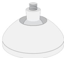
2. Fixez la caméra au support à l'aide d'un tournevis Philips. Vissez le support à vis dans la caméra, la flèche du support étant orientée vers le haut, comme sur l'image ci-dessous.
