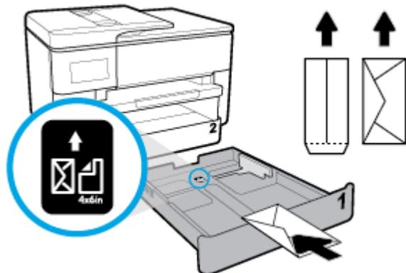
Vérifiez que la pile d'enveloppes est alignée sur les lignes de taille de papier appropriées à l'avant du bac. Vérifiez que la pile d'enveloppe ne dépasse pas le marquage de hauteur de pile figurant sur le bord droit du bac.
