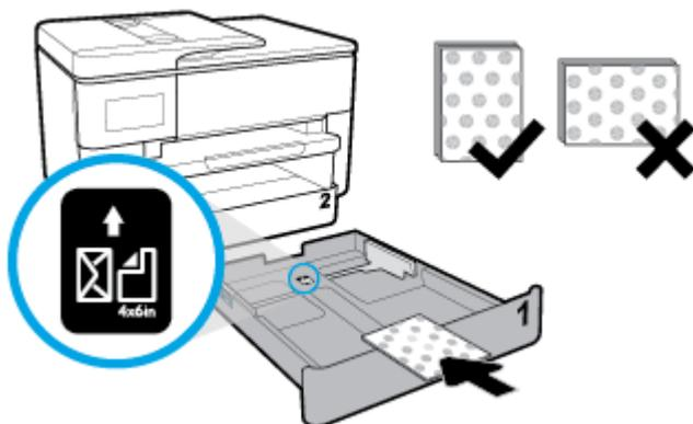
Vérifiez que la pile de cartes ou de papier photo est alignée sur les lignes de taille de papier appropriées à l'avant du bac. Vérifiez également que la pile de cartes ou de papier photo ne dépasse pas le marquage de hauteur de pile figurant sur le bord droit du bac.
