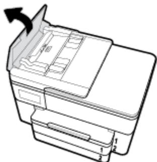
Cela permet d'accéder aisément aux rouleaux (1) et au tampon de séparation (2).
