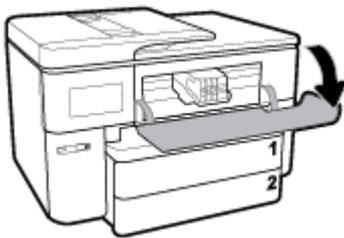
2. Si le chariot d'impression n'est pas obstrué, déplacez-le au maximum à droite de l'imprimante et éliminez le bouchage.
