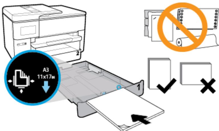
Vérifiez que la pile de papier est alignée sur les lignes de taille de papier appropriées à l'avant du bac. Vérifiez que la pile de papier ne dépasse pas le marquage de hauteur de pile figurant sur le bord droit du bac.
