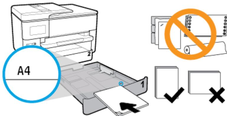
Vérifiez que la pile de papier est alignée sur les lignes de taille de papier appropriées à l'avant du bac. Vérifiez que la pile de papier ne dépasse pas le marquage de hauteur de pile figurant sur le bord droit du bac.
