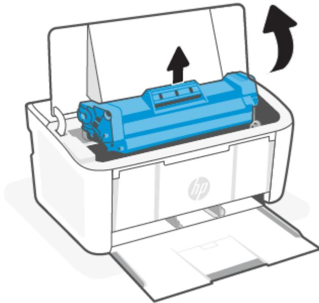
2. Maintenez la porte de la cartouche d'impression ouverte et, avec les deux mains, saisissez le côté du support le plus visible (cela inclut la partie du milieu) et tirez-le doucement hors de l'imprimante.
