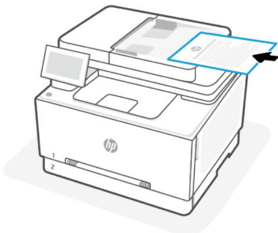
3. Ajustez les guides de largeur jusqu'à ce qu'ils entrent en contact avec le bord de la pile de papier.
