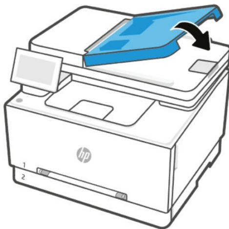
8. Ouvrez le capot du scanner. Si le papier est bloqué derrière le renfort en plastique blanc, retirez-le doucement.
