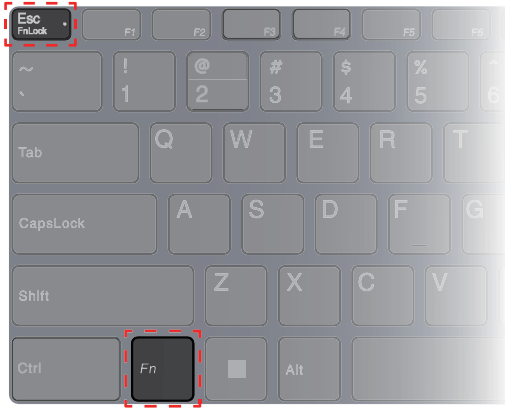
Figure 8. Emplacements des touches FnLock et Fn
