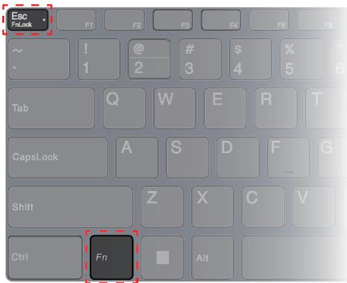
Figure 4. Emplacements des touches FnLock et Fn
