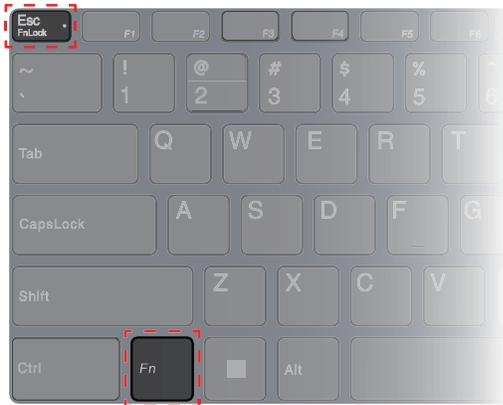
Figure 7. Emplacements des touches FnLock et Fn
