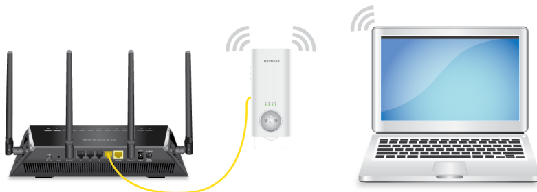
Illustration 4 : Répéteur en mode point d'accès
