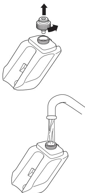
**2** Pour retirer le bouchon du réservoir d'eau, le faire tourner dans le sens contraire des aiguilles d'une montre. Remplir complètement le réservoir avec de l'eau distillée ou de l'eau du robinet.
