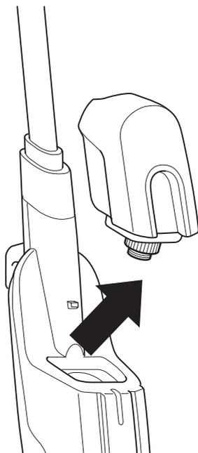
**1** Pour retirer le réservoir, le soulever et l'écarter du corps du balai vapeur. S'assurer que le balai vapeur est débranché avant de retirer le réservoir d'eau.
