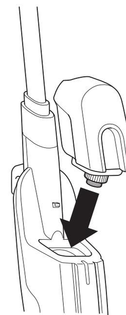
**4** Pour remettre le réservoir d'eau en place, l'aligner de manière à ce que le bouchon soit tourné vers le bas. Placer le bouchon dans le trou du corps du balai vapeur et faire glisser le réservoir vers le bas jusqu'au clic.
