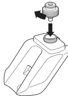
**3** Remette le bouchon sur le réservoir d'eau et le faire tourner dans le sens des aiguilles d'une montre pour le fermer.
