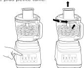
8 Une fois terminé, arrêtez l'appareil en appuyant sur le bouton marche/arrêt et attendez que le disque arrête de tourner. Appuyez sur le bouton du couvercle de la trémie situé près de la poignée pour déverrouiller et tournez le couvercle dans le sens inverse des aiguilles d'une montre. Soulevez le couvercle du bol.
