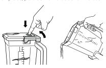
8b Pour les préparations plus compactes, retirez le couvercle et le jeu de lames superposées avant de verser le contenu du pichet. Pour enlever le couvercle, appuyez sur le bouton RELEASE (DÉVERROUILLER) et tirez la poignée. Pour retirer le jeu de lames, saisissez-le par le haut de la tige avec précaution et tirez-le vers le haut. La carafe peut alors être vidée.
