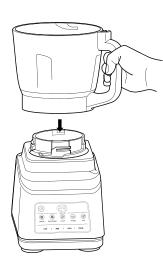
2 Abaissez le bol du robot de cuisine sur le bloc-moteur et tournez-le dans le sens des aiguilles d'une montre jusqu'à entendre un « clic ».
