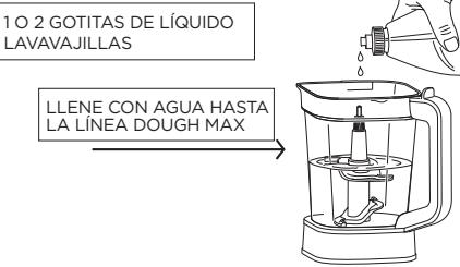
Con el juego de cuchillas montadas o para masa instalado, llene con agua tibia hasta la línea DOUGH MAX (masa máx.) y añada 1 o 2 gotitas de líquido lavavajillas. Bloquee la tapa de la jarra y asegúrese de que el pico vertedor esté bien cerrado.
