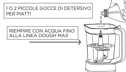
Con il gruppo lame sovrapposte o per impastare installato, riempire con acqua calda fino alla linea DOUGH MAX e aggiungere 1 o 2 gocce di detersivo per piatti. Fissare il coperchio della caraffa e assicurarsi che il beccuccio per versare sia ben chiuso.
