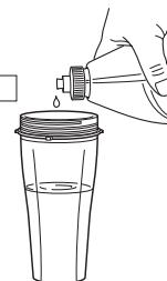
Füllen Sie sie zur Hälfte mit warmem Wasser und fügen Sie einen Tröpfchen Spülmittel hinzu. Installieren Sie die Klingeneinheit.
