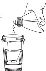
Füllen Sie die Schüssel bis zum oberen Rand des Power Paddle mit warmem Wasser und geben Sie 1-2 Tröpfchen Spülmittel hinzu. Installieren Sie die Klingeneinheit.
