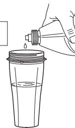
Fyll halvvägs med varmt vatten och tillsätt 1 droppe diskmedel. Montera knivsetet.
