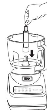
**3** Placez le mandrin de disque sur l'engrenage de disque à l'intérieur du bol.
