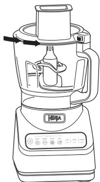
**7** Appuyez sur le bouton du couvercle de la goulotte d'alimentation situé près de la poignée pour déverrouiller et tournez le couvercle dans le sens inverse des aiguilles d'une montre. Soulevez le couvercle du bol. Retirez toujours le jeu de lames à hacher avant de vider le bol de ses ingrédients. Pour retirer le jeu de lames à hacher, saisissez-le par le haut de la tige avec précaution et soulevez-le hors du bol.
